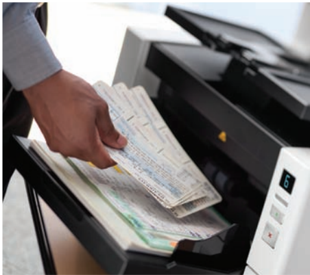
SurePath 紙張處理技術可根據文件尺寸和重量自動調整掃描器。
